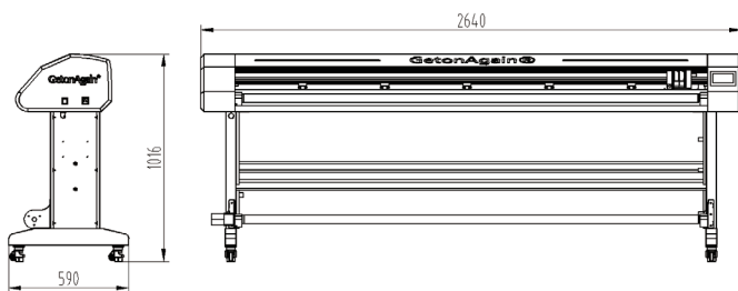
注/Re: 1800机型 —— 整机尺寸——1800Model-Machine size: 2640mm×590mm×1016mm(L×W×H)
